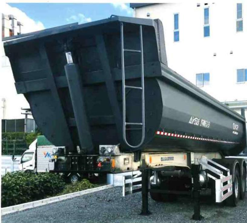
リフティング機能とランディング電動機能を装備した車両。上下昇降機能を有し、作業効率を高める。アルミシャシーで軽量化
